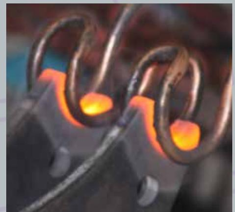
Los extremos del anclaje y la leva reciben un tratamiento térmico a más de 1,000 °F para evitar el desfiguramiento y la pérdida de la geometría de los frenos. Esto extiende la vida de los frenos y mejora el desempeño del frenado.
