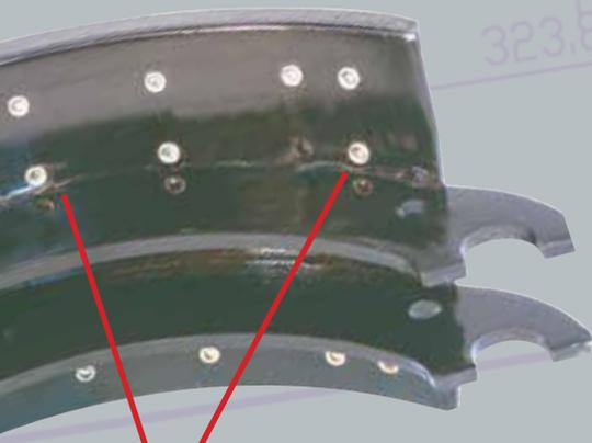
Soldaduras de ocho puntos, combinadas con 16 soldaduras superiores ofrecen un refuerzo bidireccional a la tabla más gruesa. Esta combinación evita el pandeo, el arrastre y las torceduras.
