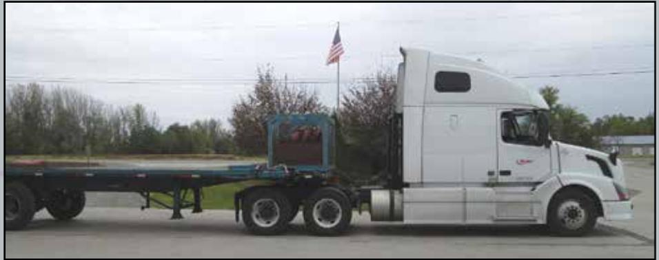
Las nuevas regulaciones de distancia de frenado reducida (RSD) exigen que los tractores de tres ejes se detengan en 250 pies o menos cuando llevan un remolque (imagen de arriba), y el 235 pies o menos para los tractores sin carga (cuando no jalan un remolque).
