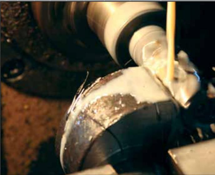
**Chumaceras pulidas con piedra hasta lograr un acabado brillante que reduce el desgaste de los cojinetes**
