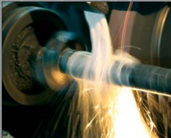
**Les tourillons moulus sur pierre avec finition ultra brillante réduisent l'usure de la bague**
