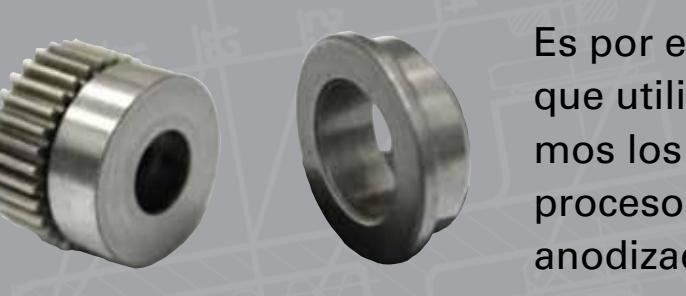
**ARRIBA:** Todos los componentes que soportan carga están fabricados con acero para herramientas alto en carbono de dureza 45 HRC. Esto garantiza una vida más larga bajo cargas de alta torsión que superan los 3,000 pie-lb.
