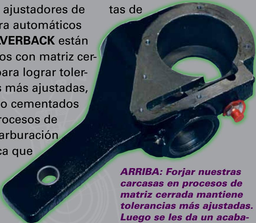
**ARRIBA:** Forjar nuestras carcasa en procesos de matriz cerrada mantiene tolerancias más ajustadas. Luego se les da un acabado de cementado con nitrocarburación ferrítica para resistir a los agentes corrosivos. Se inserta un cojinete de acero en cada carcasa para una mejor resistencia al desgaste y estabilidad dimensional. Los engrasadores permiten un mantenimiento y lubricación adecuados.
