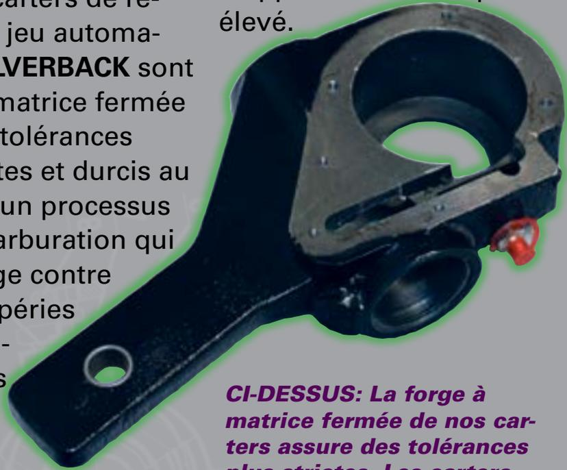
*CI-DESSUS: La forge à matrice fermée de nos carters assure des tolérances plus strictes. Les carters sont ensuite durcis au moyen d'une méthode de nitrocarburation, résistant à la corrosion. Une bague d'acier est insérée dans chaque carter pour assurer une résistance supérieure contre l'usure et une stabilité dimensionnelle. Les graisseurs assurent une lubrification et un entretien appropriés.*
